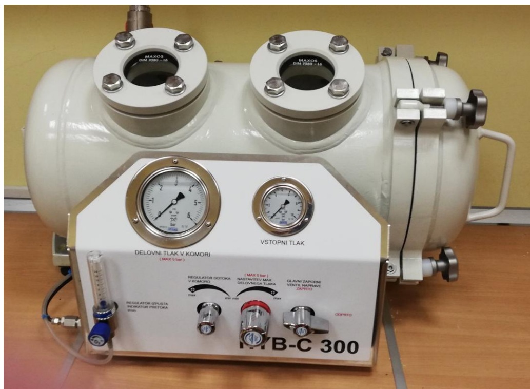
Слика 1. Изглед хипербаричне коморе за мале лабораторијске животиње (HYB-C 300, Словенија)
